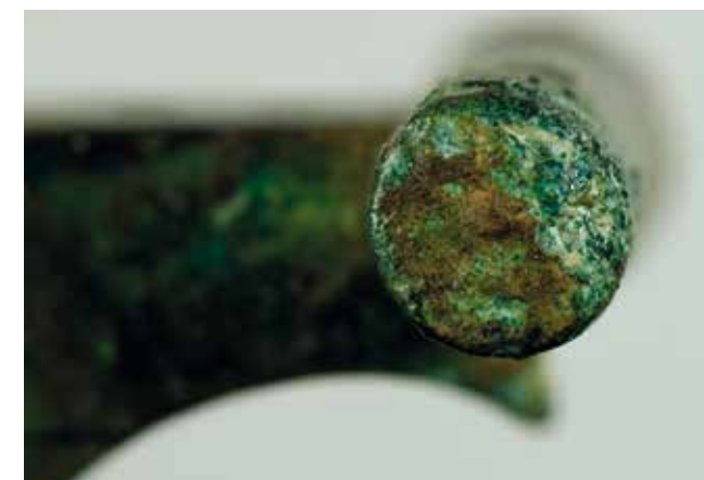
Fig. 10. Detalle da posible corrosión nun dos cilindros.
