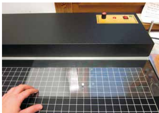
Selado das fundas mediante fusión.
