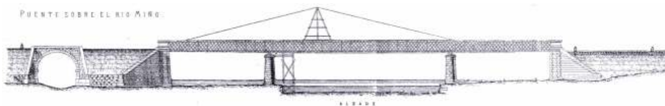
Dibujo del puente sobre el Miño. La vista es mirando aguas abajo, o sea, en dirección opuesta a la que está hecha la foto. Aparece sobre él el castillete, y junto a la pila izquierda, un caballete que también se puede ver en la foto con una ampliación grande. Este y otros dibujos del viaducto y sus piezas y mecanismos para el lanzado están en la Revista de Obras Públicas nº 3 de 1875.
