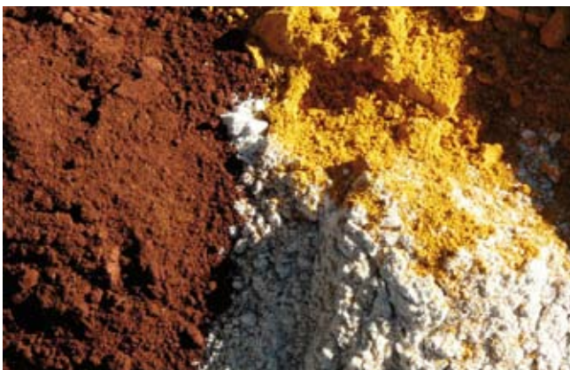
Mestura de cal hidráulico, area e pigmentos para a argamasa de conservación.
