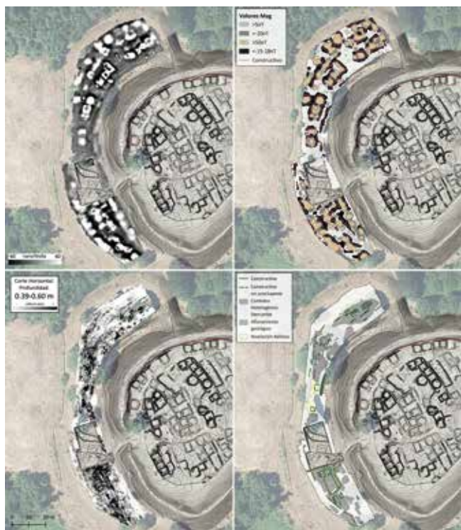
Fig.3. Resultados de la prospección magnética y georradar, con interpretación, en el antecastro oeste.
